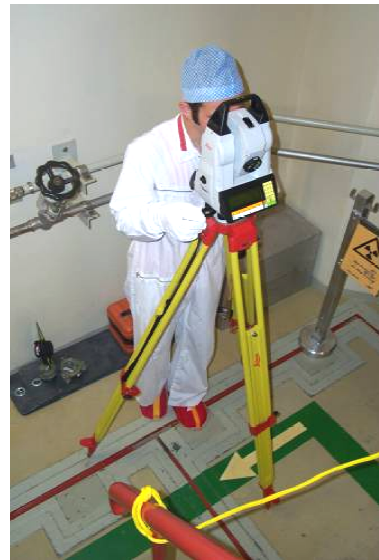
Aufnahme mit Präzisions-Industrie- tachymeter Leica TDA5005
